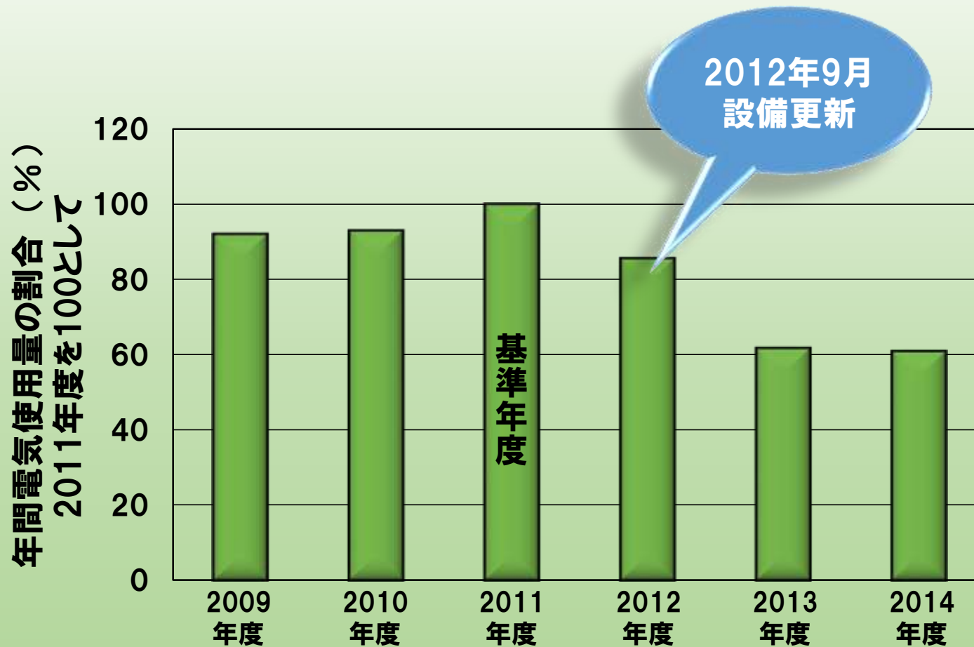
排水処理設備の年間電気使用量
